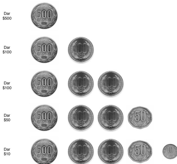
FIGURA 1.4. Algoritmo glotón usado para dar un vuelto de $760.
